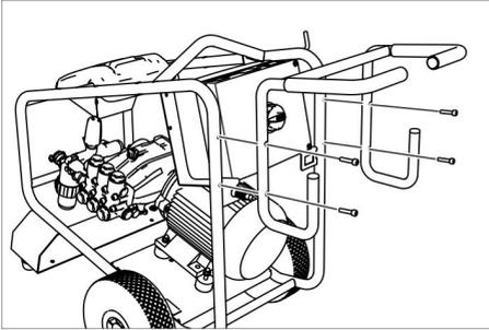
Fixați mânerul de deplasare cu șuruburile livrate împreună cu aparat.
